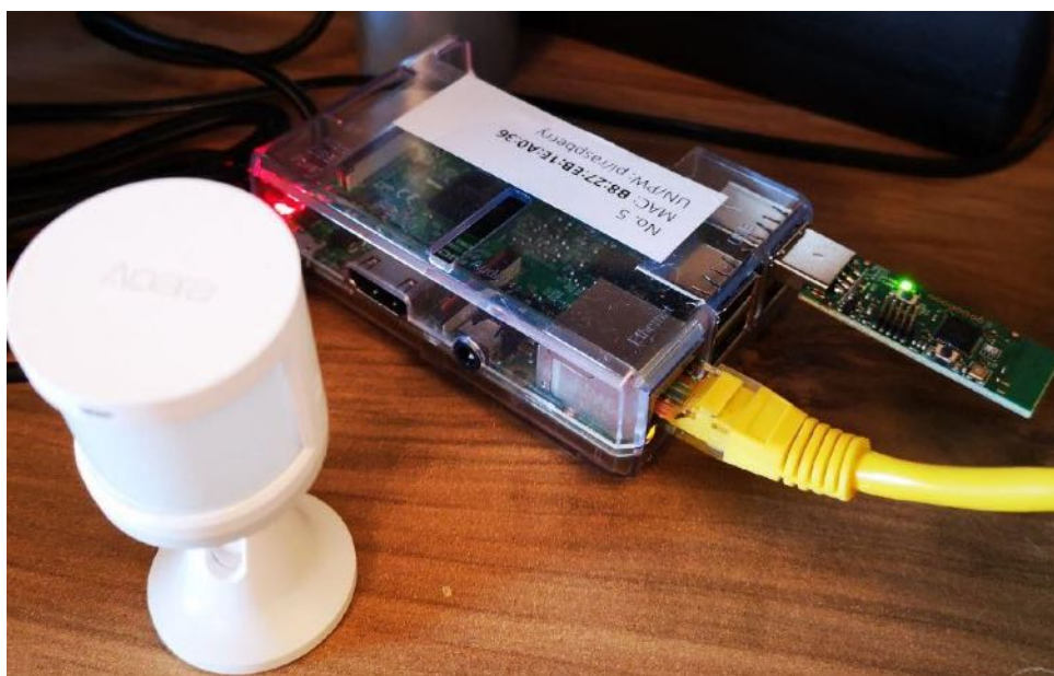
Abbildung 5.1: Raspberry Pi mit CC2531 Koordinator und Bewegungsmelder
